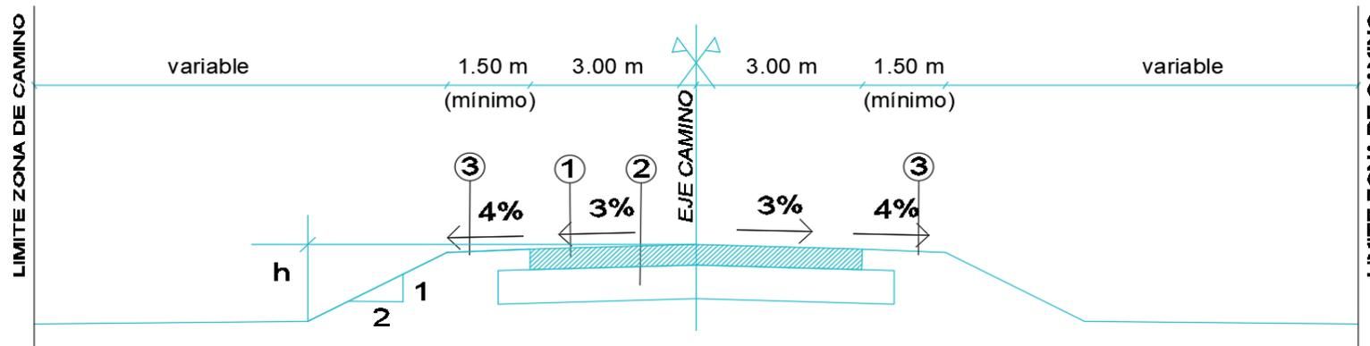
1. Estabilizado Granulométrico, en un espesor de 0,15mts y ancho de 6,00mts, de acuerdo a ETP.
