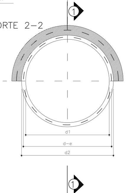
ARMADURAS LONGITUDINALES Y HELICOIDALES DE UN CAÑO DE H\* SIN PRECOMPRESION
